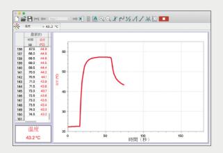
單擊「收集」後,在 Logger Pro 3中,將即時繪製圖形, 然後數據表格和儀表將持續更新
